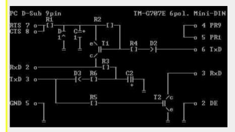
R1/R6 = 150 Ohm R2 22 kOhm R3 10 kOhm R4 33 kOhm R5 15 kOhm C1/C2 = 1 uF/16V Elko D1 = Z-Diode 5,1 Volt D2/D3 = 1N4148 oder aehnlich T1 = BC558A oder aehnlich T2 = BC337 oder aehnlich
