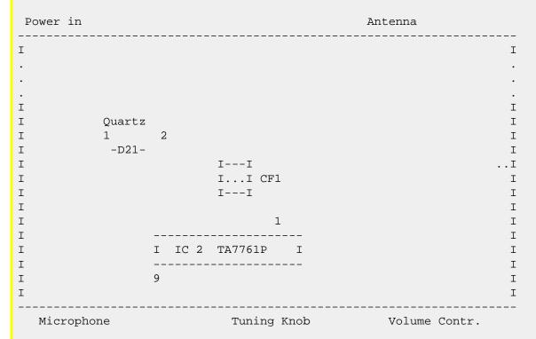
PIN 9 of IC 2 -----> - Capacitor (100nF) ----> -RX-Audio G3RUH-Modem
