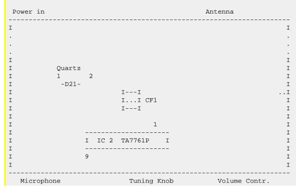
IC 2 Discriminator PIN 9 of IC 2 -----> - Capacitor (100nF) -----> -RX-Audio G3RUH-Modem
