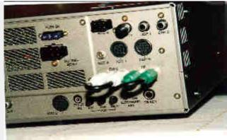
Diese muß man für den normalen KW-Betrieb nur außen mit Cinch-Cinch-Koaxkabeln brücken. Da es sich um Kurzwelle (d.h. f < 30MHz) handelt, dürfte die auftretende Dämpfung vernachlässigbar sein.
