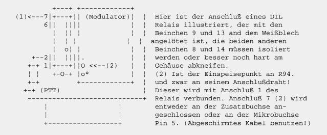
Pin 6 des Relais wird quer über das Gehaüse mit Pin 9 (Masse) verbunden.
