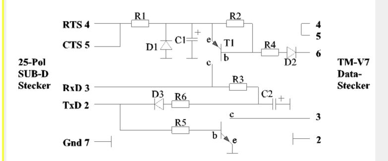
Platinenlayout für PG-4S-Adapter im SUB-D 25-Pol-Gehäuse:
