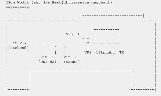
Bei den anbringen der RX-Leitung ist zu beachten das diese am besten an der Platinen-Seite angel|tet wird!! Im Bild oben sieht man die Best} ckungsseite !!
