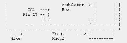
Wenn man vom linken Rand des IC's (pin 1) langsam nach links zählt bis 13 ! (kann ja jeder Funkamatuer hi) so hat man den Anschluss- punkt. Mit feiner Spitze und ruhiger Hand kann man hier den Draht anlöten, der entweder zu Mike Buchse Pin 6 führt oder zur Zusatz- buchse.
