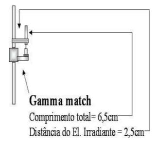
Normalmente, o que se vê, é o Gamma posicionado na frente do elemento Irradiante. Porém, neste projeto, o Gamma Match, deve ser posicionado ao lado do Elemento Irradiante (qualquer lado, exceto se você resolver empilhar esta antena, e neste caso, deve ser colocado do lado externo). Nada deve ficar entre os Elementos Refletor, Irradiante e Diretores, para não atrapalhar o ajuste da antena, bem como o seu desempenho que é excelente e esta antena é
