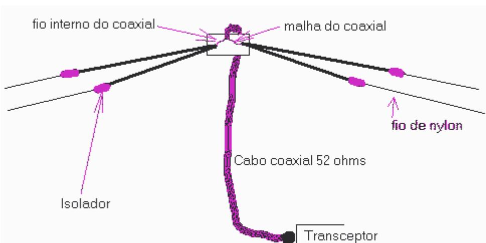
3,700 Khz comprimento do fio 38,54 metros. Cada lado da antena 19,27 metros
