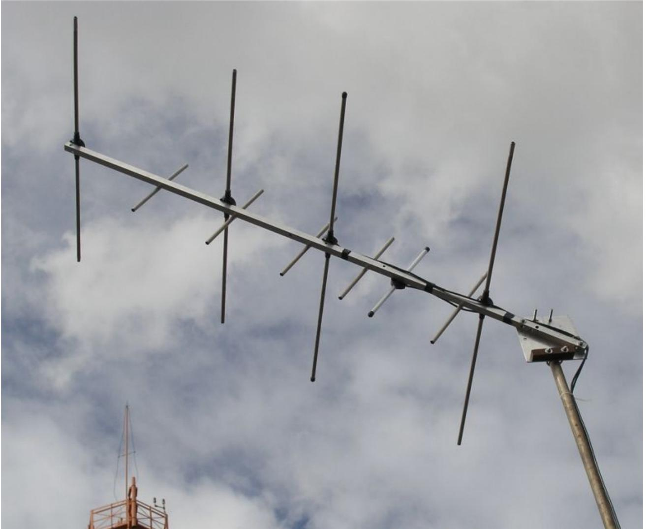
Cada antena tem um cabo independente, e os dois são ligados a um diplexador, para utilização em equipamento V/U com apenas um conector. Caso o equipamento tenha conectores separados para V e U, o diplexador não precisa ser usado.
