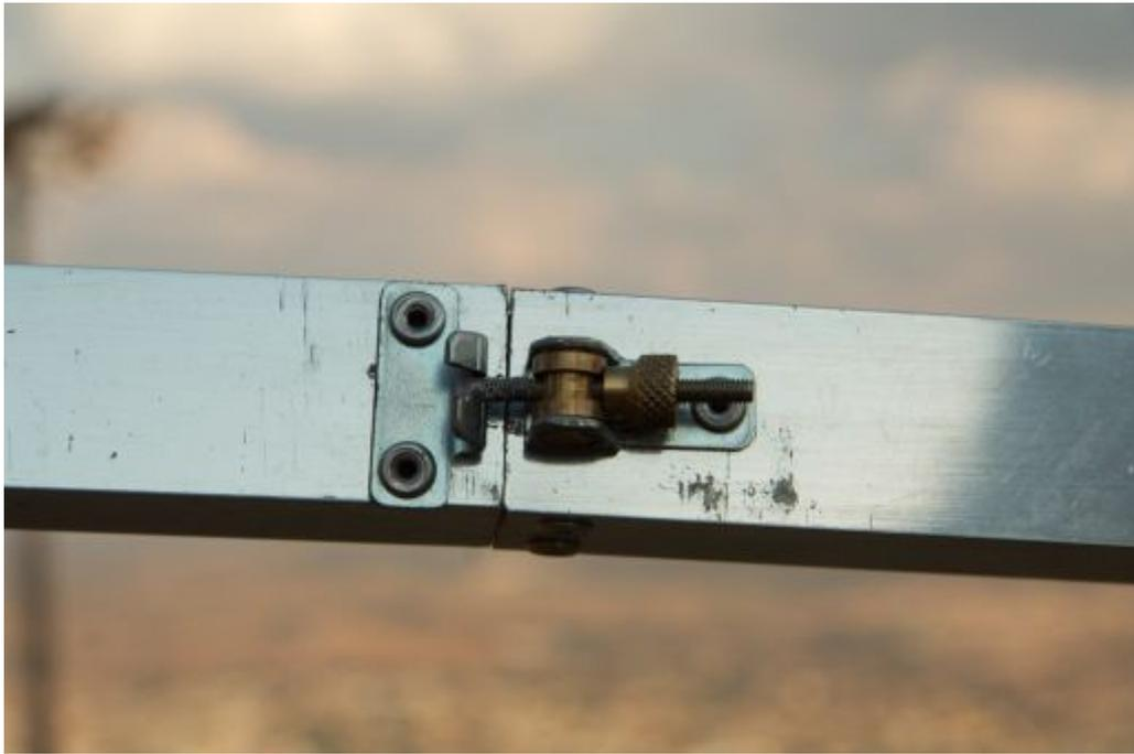
Detalhes do isolador e suporte do elemento radiante (dipolo aberto), com os bornes de fixação do cabo coaxial, antes e depois de fixado ao boom:
