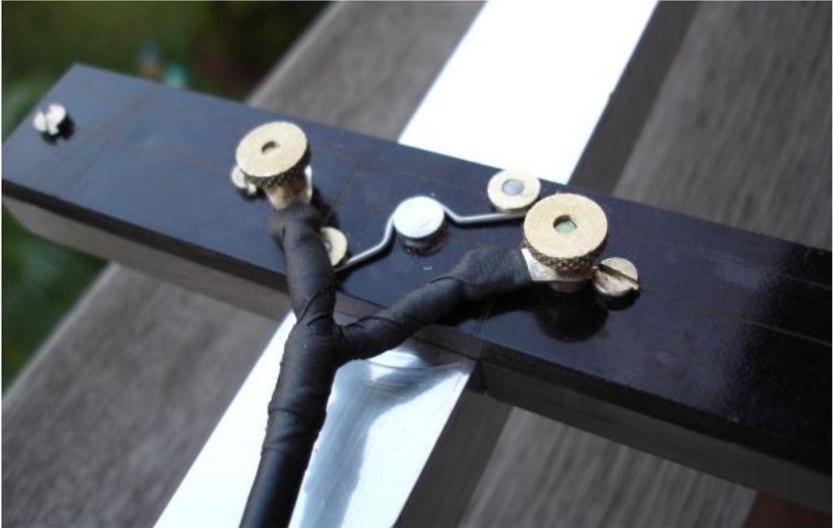
Detalhe da fixação dos elementos, que tem dois pequenos sulcos, separados pela largura do boom, no caso 26 mm, onde se encaixam as presilhas flexíveis de arame de aço, uma de cada lado do boom:
